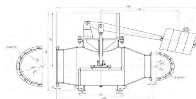
Клапаны предохранительные грузовые устанавливаются на горизонтальных участках трубопроводов в положении штоком вверх. Для крепления к строительной конструкции корпус предохранительного грузового клапана снабжен опорными лапами.
